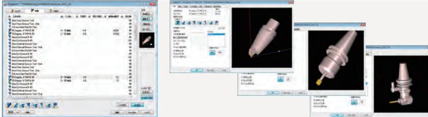
ミリングおよび旋盤工具を登録できます。必要により、工具ホルダの登録や材質ごとの切削条件も登録可能です。また、アングルヘッドやユニバーサルヘッドといった3D形状のホルダ登録も可能で、シミュレータ内においての干渉チェックに利用できます。
