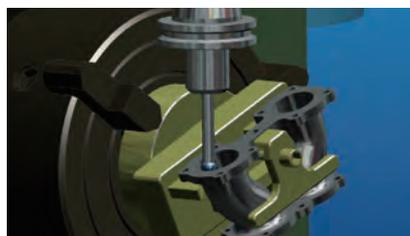
5軸加工コマンドでは、より詳細な工具制御が可能です。例えば、このコマンド内で球形エンドミルを使用したポート加工も設定できます。この他にも、Tスロットやテーパー工具などさまざまな工具をサポートしています。
