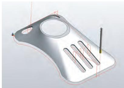
3D輪郭加工などで3Dワイヤフレームの加工が可能です。サーフェスの面枠線や、ソリッドデータの稜線を抽出したワイヤフレームから簡単に加工パスを作成できます。
