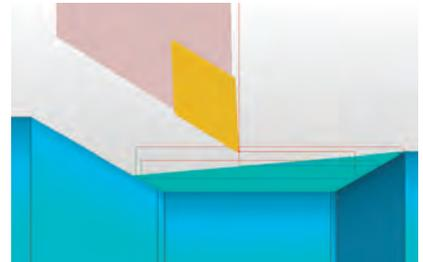
荒取りや仕上げにおいて、切残し部を別の工具で加工するため、現在のワークの状態を認識して、切り残っている部分だけを自動的に検出して加工できます。ワークの仮想オフセットにより、エアカットの最少化と安全性を両立します。
