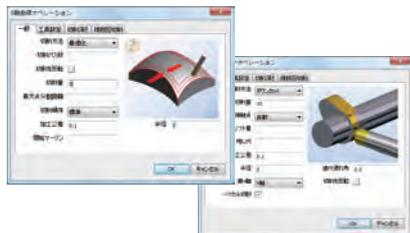
複雑なパラメータを必要とする同時4/5軸加工もスワーフ加工、ロータリー加工、曲面仕上げ、曲線沿いなどの用途ごとに最適化された「オペレーション」コマンドにより、最小限の設定で加工パスを作成することができます。
