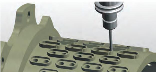
C軸を割り出して、側面上の径方向の穴を加工できます。ミリングのシステムと同様に、さまざまな穴あけのパターンを利用できますので、固定サイクルを超えた加工方法が可能です。
