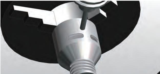
C軸を回しながら、円筒面に巻きつけた溝やポケットを加工できます。展開図から自動的に巻きつけるロータリー加工もできます。また、Edgecam Solidマシニストにより、ソリッドモデルからフィーチャーとして検出することも可能です。
