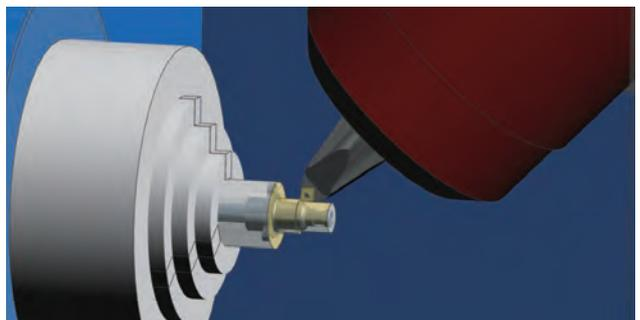
傾斜した工具を使用した旋盤加工はすべての旋盤のシステムでも利用可能ですが、特にB軸を搭載した複合加工機においては、ヘッドの大きさの課題を回避するときにも多用されます。
