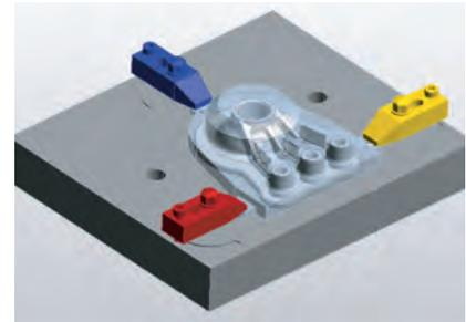
治具を定義することで、治具への干渉チェックはもちろん、途中での治具交換による削り残しの認識も可能です。工具パス作成時には、治具からの逃がし量も設定可能です。
