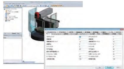
各GコードやMコードの変更は設定箇所の数字を変更するだけです。また、回転軸やワードアドレスの変更もデータフォーマット内にて変更可能です。工作機械の最高回転数や可動範囲などの定義によって、NCデータの出力エラーを警告します。
