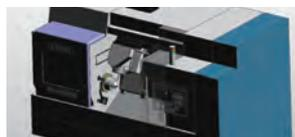
複合加工機 1タレット(ATC)+2スピンドルメインスピンドルからサブスピンドルへのワーク移動も再現できます。
