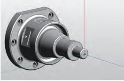
CADからの出力モデルは、加工に適切な座標方向に向いているとは限りません。ソリッドのフェースをクリックするだけで、ミリングや旋盤に適した方向や位置に合わせることができます。
